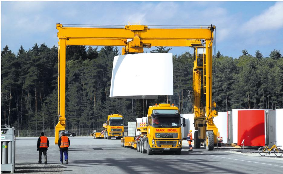
Verladen von Betonfertigteilen auf Schwertransporte, Werksgelände Max Bögl
