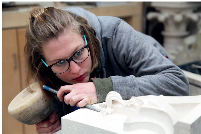
Die 23-jährige Magdalena Roland, Deutschlands beste Nachwuchs-Steinmetzin, bei der Arbeit an ihrem Gesellenstück, einem detailscharf gefertigten Blendmaßwerk aus hellem Kalkstein. Roland hat ihre Ausbildung an der Dombauhütte des Staatlichen Bauamts Passau absolviert. Foto: Staatl. Dombauhütte Passau
