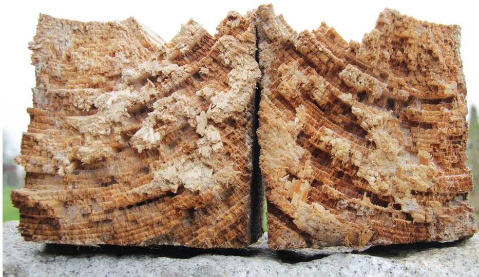
Holz nach der chemischen Zersetzung der Zellwände. © www.ingkrause.de
