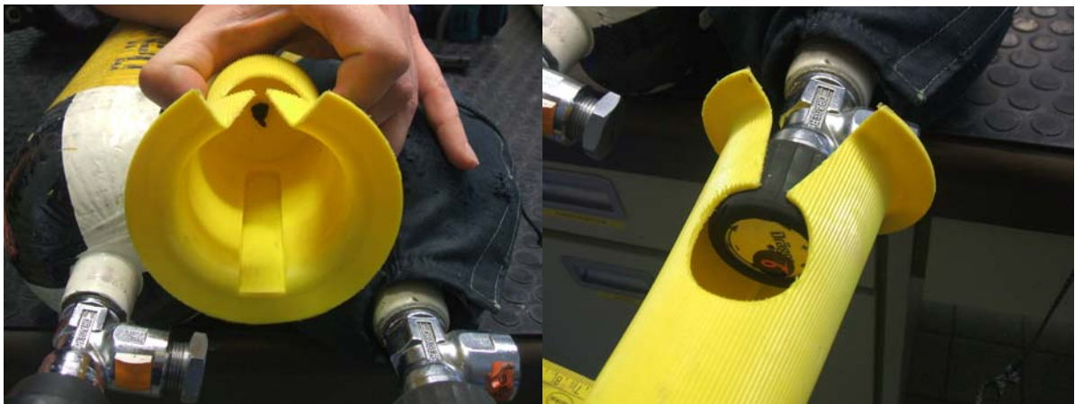
Bild 2 und 3: Schutzkappe für die Pressluftflasche
