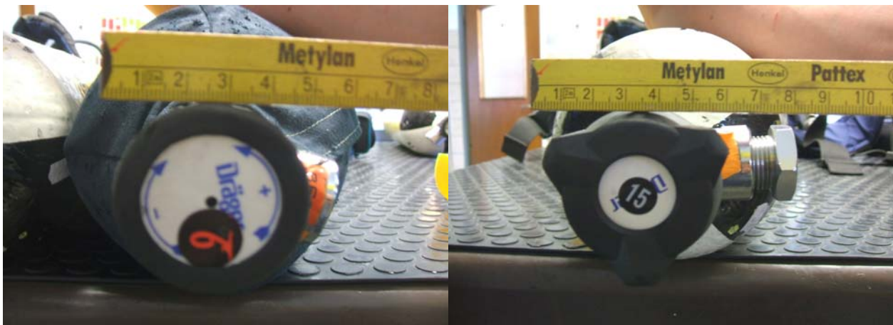
Bild 4: rundes Handrad alter Bauart Bild 5: dreieckiges Handrad neuer Bauart
